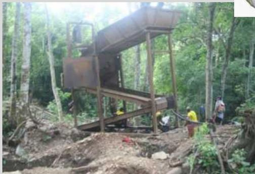
**Maquina para extracción de minerales como oro, plata, cobre, etc. Maquinas extractoras de oro que no usan químicos como mercurio.**
